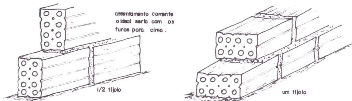
Figura 1 - Execução de alvenaria utilizando tijolos furados.
